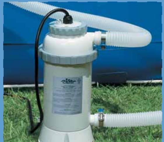
*Conçu avec une résistance électrique compatible aux traitements par stérilisation au sel, il dispose de nombreux systèmes de sécurité : détecteur de niveau d'eau, double protection thermique (thermostat 38°C et fusible 70°C), coupe circuit en cas d'inclinaison, indice de protection IPX5.*
